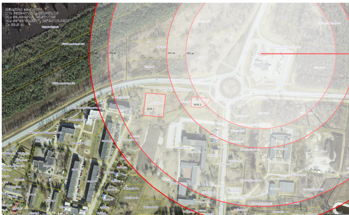
Joonis 1. AS Olerex tankla bensiinitsisterni BLEVE ohualad ja DP hoonestusala paiknemine. Allikas: geoportaal.maaamet.ee.
